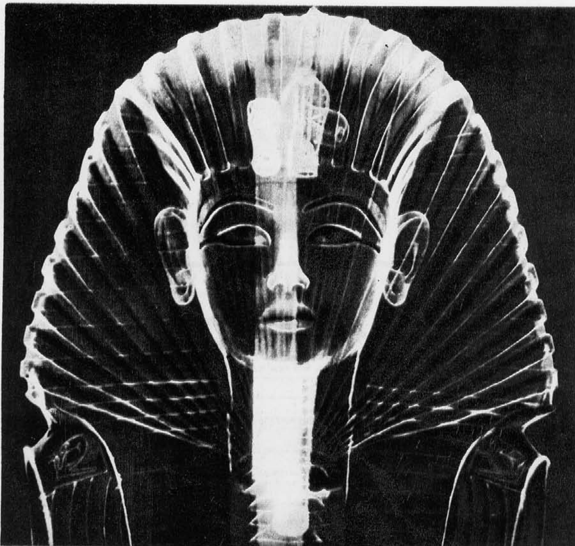
ЗОЛОТАЯ МАСКА ТУТАНХАМОНА (XIV в. до н. э.) Выглядит монолитной. Однако интроскопия в гамма-лучах, проникающих даже сквозь золото, позволила установить, что маска изготовлена из двух частей, скрепленных между собой (светлая полоса в центре). 1967
